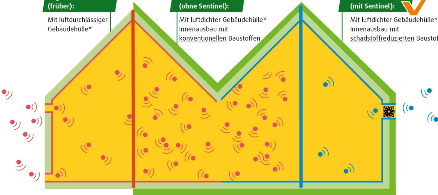
— Gebäudehülle — Dämmung — konventionelle Baustoffe — emissionsoptimierte Baustoffe — Lüftungsanlage
